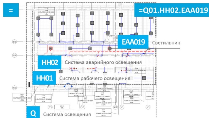
Составной идентификационный код для элемента «Светильник»
